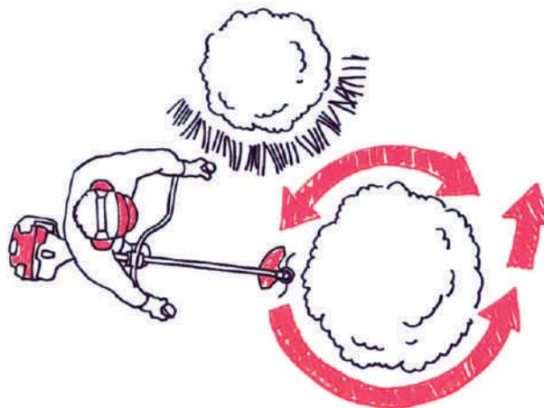
Кошение возле препятствий производится кольцевым методом, режущий инструмент используется, как правило, леска.
