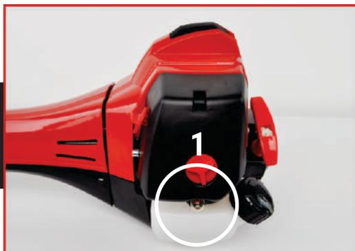
**1.** Подкачать топливо ручным топливным насосом.
