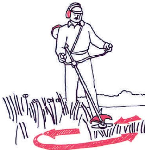
При очень высокой траве косить в два приема: сначала верхнюю половину растений, потом нижнюю.
